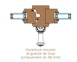
Coef. UW jusqu'à 1,3 Coef. SW entre 0,38 et 0,44
